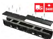
Žlab venkovní AVZ103-R201 100mm s pozinkovaným rámem s litinovým roštem D400
